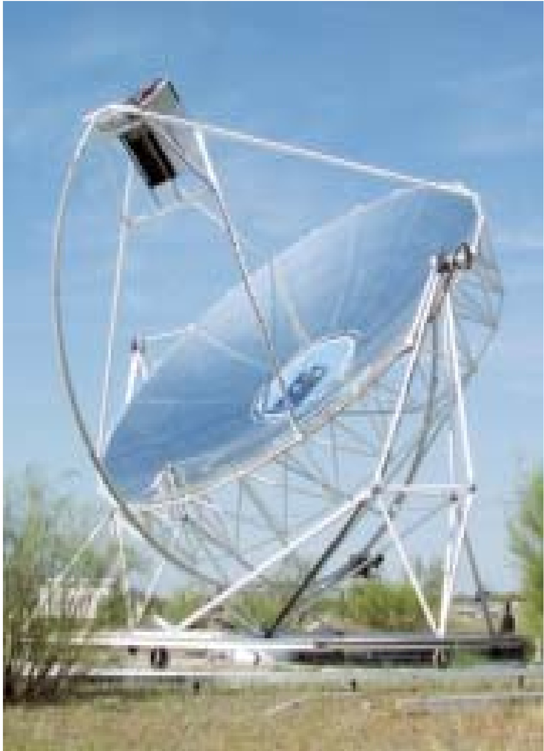
Σχήμα 30.1 Ηλιακός Συγκεντρωτικός Συλλέκτης με Σχήμα Παραβολικού Πιάτου
